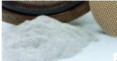
Das Ergebnis: gereinigte und damit wieder einsatzbereite Dieselpartikelfilter mit typischen Ascherückständen.
