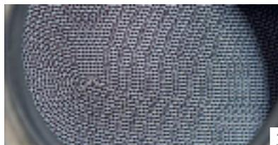
Erneute Einsatzbereitschaft: Der Filterquerschnitt offenbart den vollständig gereinigten Partikelfilter.
