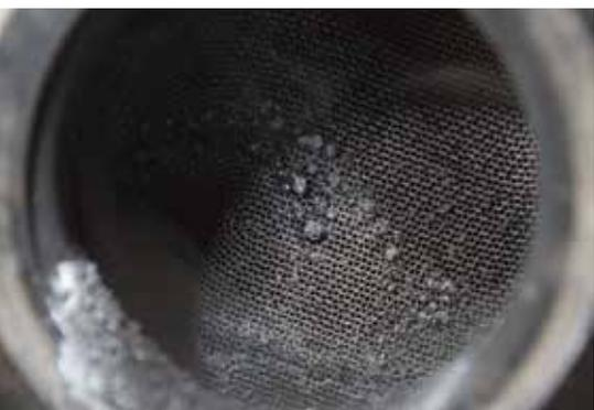
im Abgas so auszulegen, dass eine regelmäßige Wartung, d.h. die Entfernung der ausgefilterten Massen immer höchste Filterraten ermöglicht. Denn ein verstopfter Filter führt zwangsläufig zu erhöhtem Kraftstoffverbrauch, deutlichem Leistungsverlust bis hin zum Totalausfall. In den vergangenen Jahren haben sich eine Vielzahl von Reinigungsverfahren am Markt mit unterschiedlich hohen Reinigungsraten etabliert.
