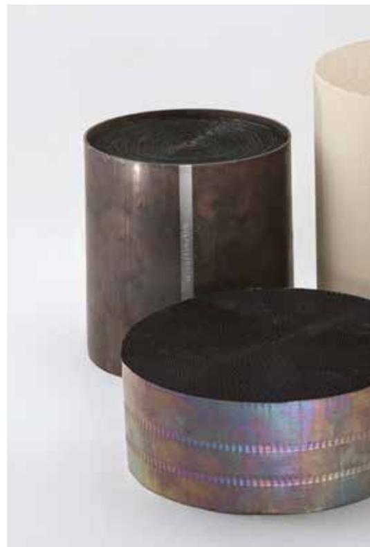
► *Filter im Anschluss an die Reinigung.*
